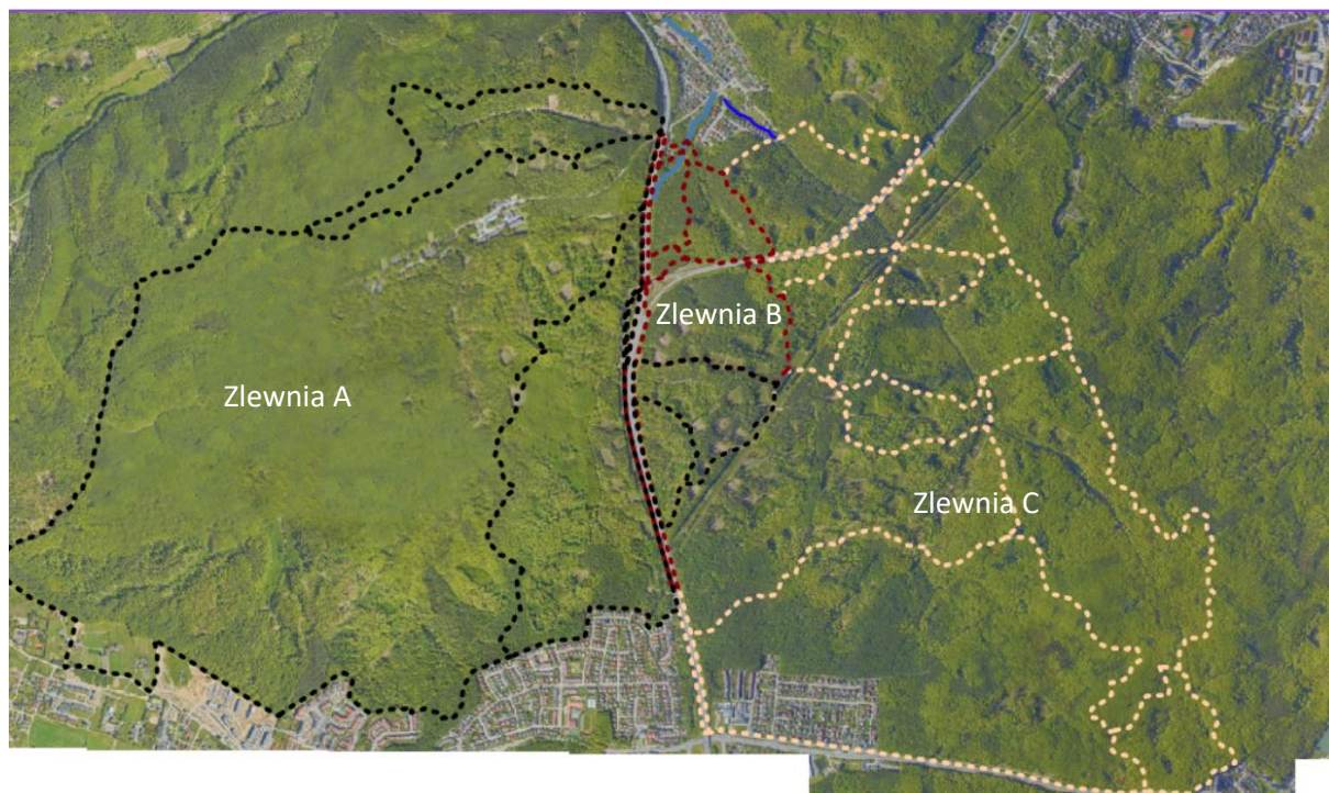
Rysunek 4. Granice górnej części zlewni Potoku Demptowskiego- zlewnia zbiornika retencyjnego przy ul. Komandora Sakowicza; kolorem czarnym oznaczono zlewnię A do przekroju zamykającego przy wiadukcie obwodnicy trójmiejskiej; kolorem czerwonym zlewnie B do przekroju zamykającego piaskownika przy ul Sakowicza, kolorem pomarańczowym zlewnie C do przekroju zamykającego zbiornika przy ul. Sakowicza
